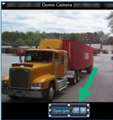
4. オーバーレイボタンのテキストを変更するには、テキストをダブルクリックして上書きし、続いてチェックボックス  を選択して保存します。元に戻すには、キャンセルボタン  をクリックします。保存するときに、テキストはボタンで最大限のサイズになります。
