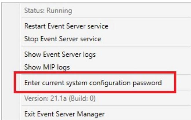
2. 現在のシステム構成パスワードを入力するには、**現在のシステム設定パスワードを入力**をクリックします。ウィンドウが表示されます。
