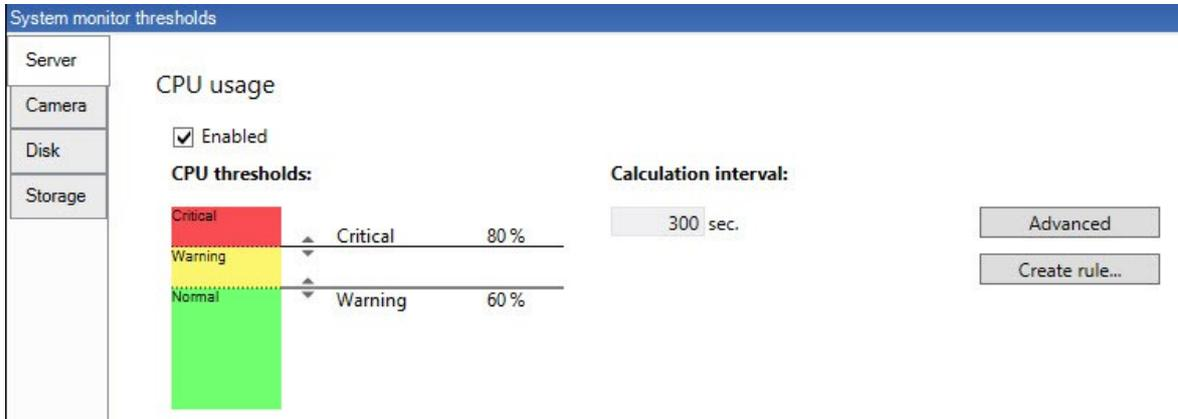
3. しきい値コントロールスライダを上下にドラッグし、しきい値を増減します。しきい値コントロールに表示される各ハードウェアで使用可能なスライダは2つあり、これによって[正常]、[警告]、[重大]状態が識別されます。
