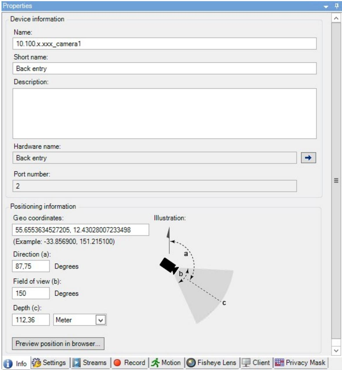
4. **地理座標**フィールドで、緯度、経度の順に指定します。小数点としてピリオドを使用し、緯度と経度を分けるためにコンマを使用します。
