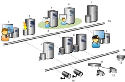
分散型システム設定の例。カメラおよびレコーディングサーバーの数と、接続できるクライアントの数は、必要なだけ増やすことができます。
