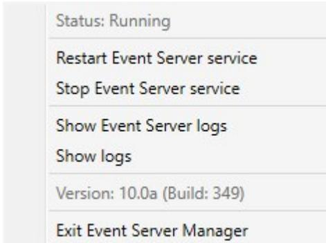
2. サービスが停止した場合は、**Event Serverサービス開始**をクリックして開始します。トレイアイコンが変わり、新しいステータスを示します。
