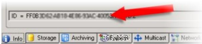
2. 新しいレコーディングサーバーで、レコーディングサーバーIDを置き換えます。
