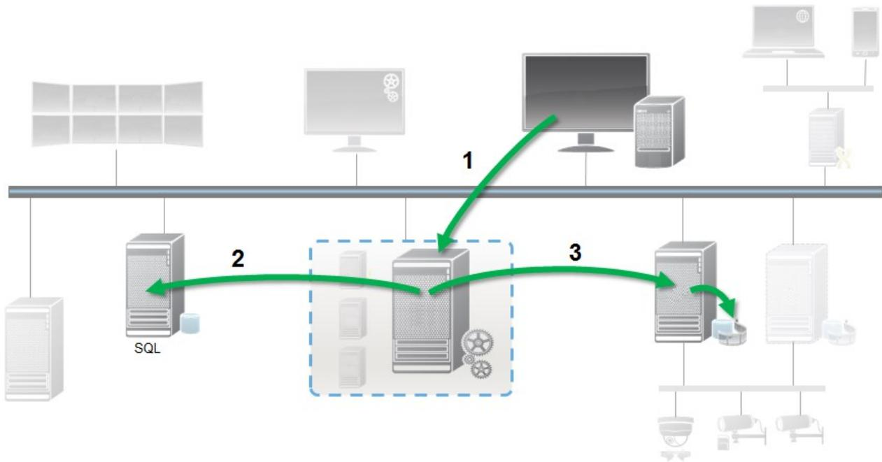
1. XProtectSmartClientのユーザーがエビデンスロックを作成します。情報がマネジメントサーバーに送信されます。
