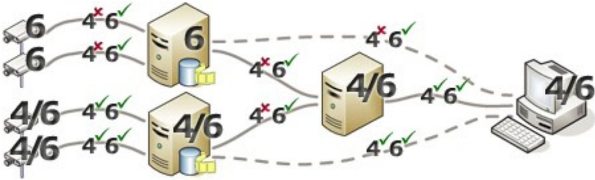
例：システム内の1つのサーバーが、IPv6のみを使用しているため、そのサーバーとのすべての通信で、IPv6を使用する必要があります。ただし、そのサーバーはシステム内のすべての他のサーバー間の通信に使用されるIPバージョンも決定します。
