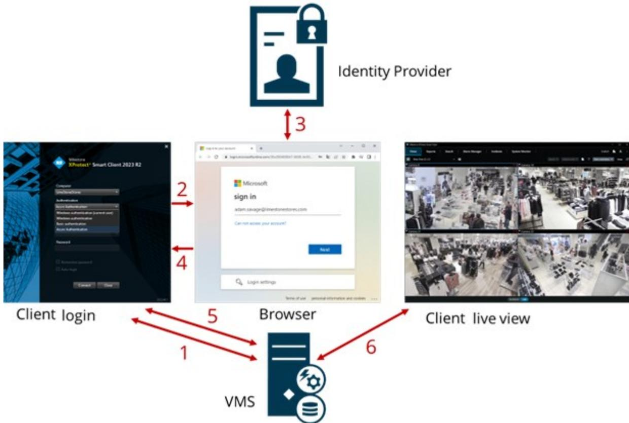
1. XProtect Smart ClientまたはXProtect Management Clientの[コンピューター]フィールドに、XProtectVMS コンピュータのアドレスを入力し、[認証]で外部IDPを選択します。[ユーザー名]および[パスワード]フィールドが無効になります。
