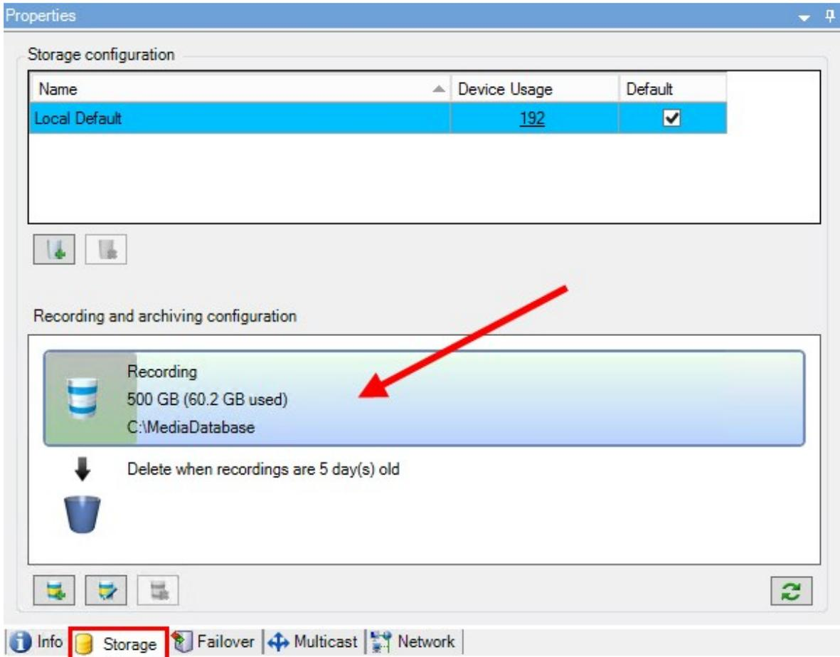
5. 録画およびアーカイブ設定セクションで、録画データベースを表す水平バーをダブルクリックします。ストレージとレコーディングの設定 ウィンドウが現れます。
