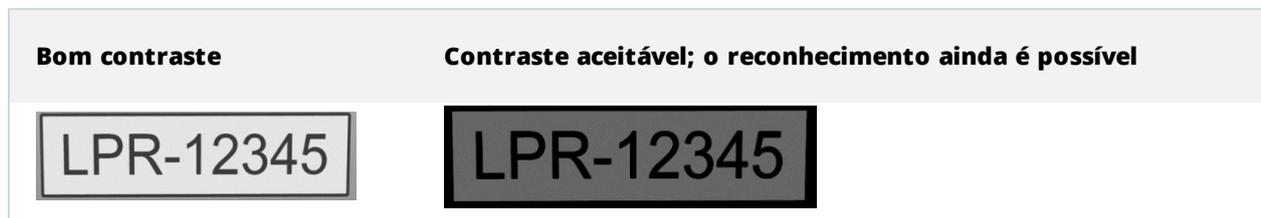
Pixels de uma imagem em tons de cinza de 8 bits podem ter valores de cores que variam de 0 a 255, onde o valor em tons de cinza 0 é preto absoluto e 255 é branco absoluto. Quando converter sua imagem de entrada para uma imagem em tons de cinza de 8 bits, a diferença mínima do valor de pixel entre um pixel no texto e um pixel no fundo deve ser de pelo menos 15.
