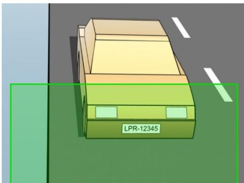
Numa foto, certifique-se de que os parâmetros de largura do traço e largura da placa, conforme descrito a seguir, foram atendidos. Use um editor de imagens comum para medir a quantidade de pixels. Ao iniciar o processo de definição da largura mínima da placa de licença, comece com uma resolução baixa na câmera e vá aumentando até chegar à largura de placa necessária.
