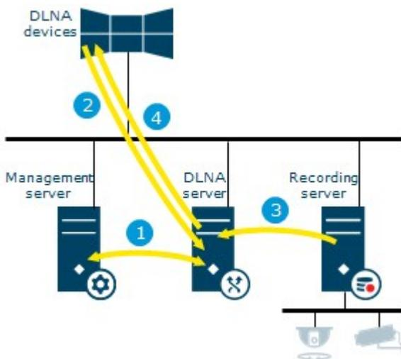
1. Pendant le démarrage du service de XProtect DLNA Server, le XProtect DLNA Server se connecte au serveur de gestion afin de s'authentifier avec les identifiants de connexion fournis. Une fois l'autorisation obtenue, le XProtect DLNA Server démarre. Il est prêt à envoyer des flux vidéo H.264 depuis les caméras aux périphériques DLNA.
