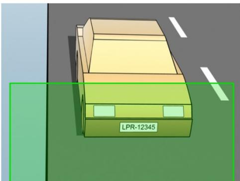
Machen Sie eine Momentaufnahme und stellen Sie sicher, dass die Anforderungen für Strichbreite und Nummernschildbreite erfüllt werden, wie unten beschrieben. Messen Sie die Pixelanzahl mithilfe eines Standard-Bildbearbeitungsprogramms. Beginnen Sie den Prozess zum Erreichen der minimalen Nummernschildbreite mit einer niedrigen Auflösung der Kamera und arbeiten Sie sich dann zu einer höheren Auflösung hoch, bis Sie die erforderliche Nummernschildbreite erreicht haben.
