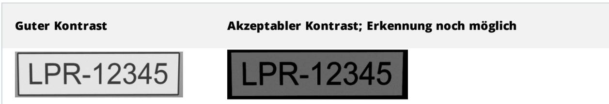
Die Pixel in einem Bild mit einer 8-Bit-Graustufe können Farbwerte zwischen 0 und 255 haben, wobei ein Graustufenwert von 0 völlig schwarz und 255 schneeweiß ist. Wenn Sie Ihr Eingangsbild in ein Bild mit einer 8-Bit-Graustufe umwandeln, sollte der minimale Unterschied beim Pixelwert zwischen einem Pixel im Text und einem Pixel im Hintergrund bei mindestens 15 liegen.
