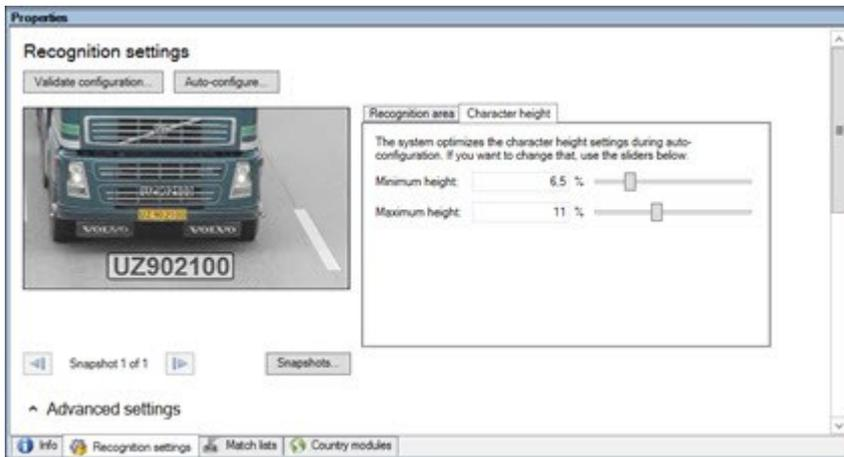
Das Overlay in der Momentaufnahme zeigt die aktuell festgelegte Einstellung für die Zeichenhöhe an. Das Overlay wird proportional zu den auf der rechten Seite für die Zeichenhöhe festgelegten Einstellungen vergrößert oder verkleinert. Für den einfachen Vergleich ziehen Sie das Overlay über das tatsächliche Nummernschild in der Momentaufnahme. Zoomen Sie für einen näheren Blick mit Ihrem Mausrad heran.
