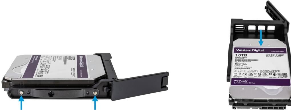
4. Individuare l'unità disco rigido sostitutiva e far scorrere l'unità nel vassoio. Utilizzare le quattro viti per fissare il disco rigido al vassoio.
