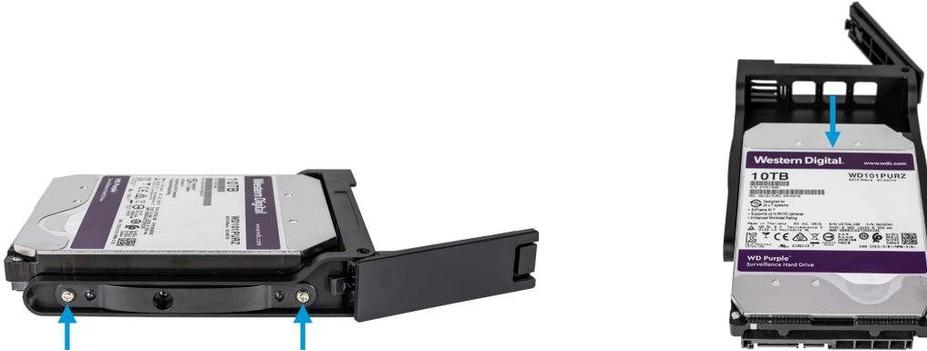
4. Localice el disco duro de sustitución y deslícelo en la bandeja. Use los cuatro tornillos para fijar el disco duro a la bandeja.
