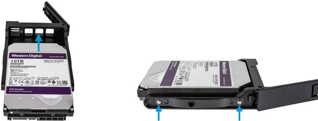
2. Verwenden Sie die mitgelieferten Schrauben zur Montage der Festplatte an vier Punkten im Schacht mit zwei Schrauben an jeder Seite.
