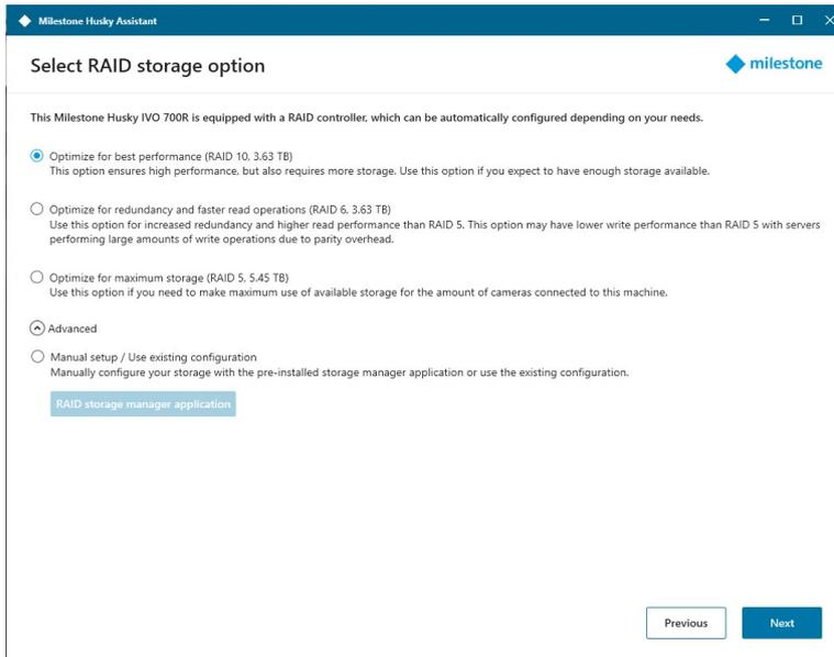
L'opzione **Avanzate** permette di configurare manualmente il RAID utilizzando l'applicazione di gestione dell'archiviazione RAID.
