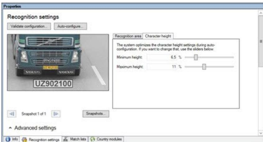
A sobreposição na foto mostra a configuração atualmente definida para a altura dos caracteres. A sobreposição aumenta e diminui proporcionalmente às configurações de altura dos caracteres para a direita. Para fins de comparação fácil, arraste a sobreposição para cima da placa de licença real na foto. Dê zoom com o botão de rolagem de seu mouse para olhar mais de perto.
