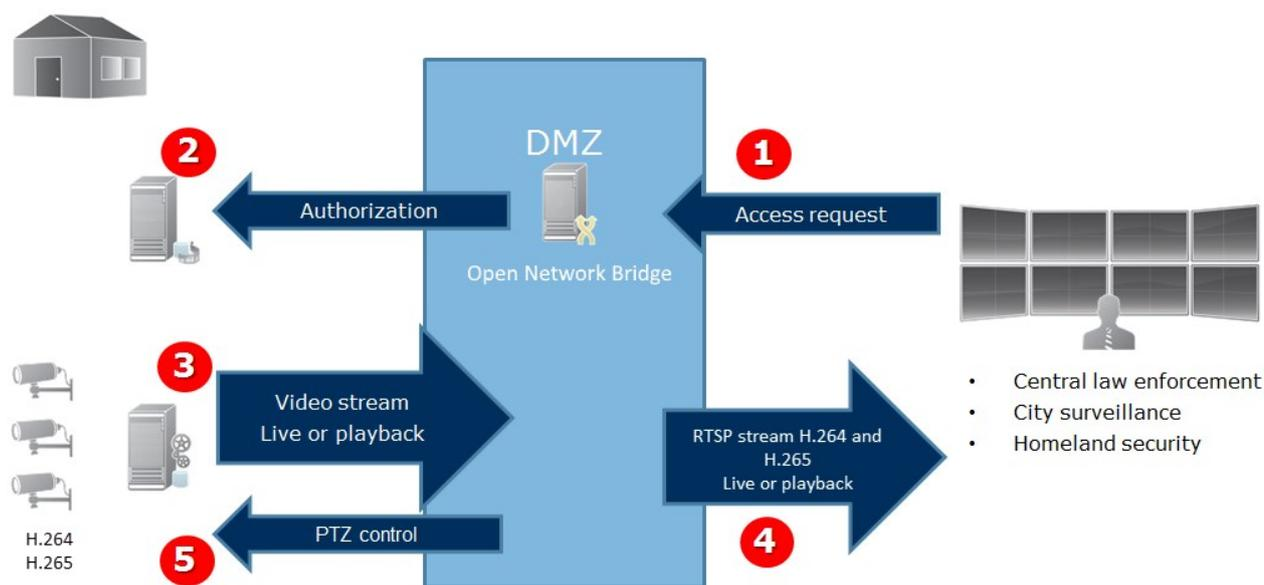
1. Ein ONVIF-Client verbindet sich mit dem XProtect VMS mittels des Milestone Open Network Bridge-Servers über das Internet. Hierfür benötigt der ONVIF-Client die IP-Adresse oder den Domainnamen (Domain/Hostname) des Servers auf dem Milestone Open Network Bridge installiert ist, sowie die Nummer des ONVIF-Ports.
